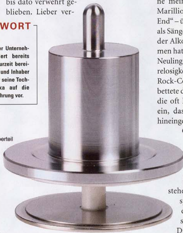
Der Plattenteller schwebt fast völlig reibungsfrei auf Clearaudios neuem Magnetlager und ist so wirksam entkoppelt. Der Unterschied zu anderen magnetischen Lagern besteht vor allem in der Lagerachse aus Keramik
