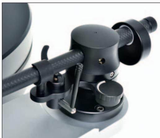
Drehzahlwechsel auf Knopfdruck an der schweren Motordose (links), die mit einem „bauchigen“ Pulley ausgestattet ist, damit der Flachriemen nicht an den Rändern des Pulleys reibt. Der Tonarm verfügt über ein Schräglager, Kohlefaser-Armrohr und Clearaudios magnetische Antiskating-Vorrichtung.
