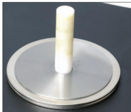
Die Achse des invertierten Tellerlagers besteht aus hohler, geschliffener und polierter Keramik, deren Lauffläche superglatt ist. Das Gegenstück ist eine Hülse mit Sinterbronzebuchse, die magnetisch schwebend und damit horizontal reibungsfrei den schweren Kunststoffplattenteller trägt.
