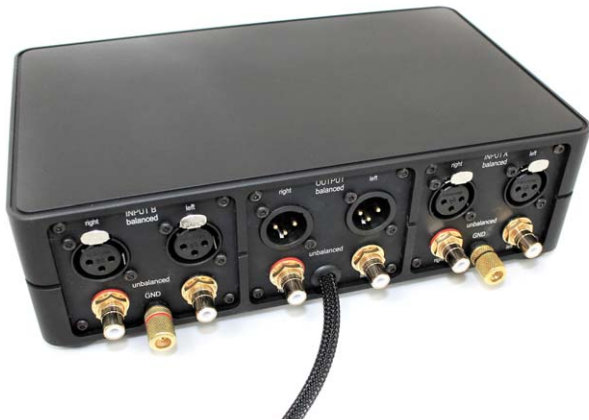
Anschlussfeld des Clearaudio Balance Reference Phono: Die beiden Eingangsbereiche links und rechts und der mittige Ausgang halten symmetrische wie unsymmetrische Anschlüsse vor
