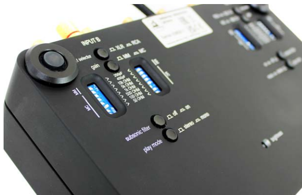
Sämtliche Einstellungen zur Anpassung an den Tonabnehmer geschehen beim Balance Reference Phono auf der Unterseite der Verstärkereinheit
