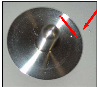
Abbildung 2: Übereinstimmung der Markierung Plattenteller und Lager
