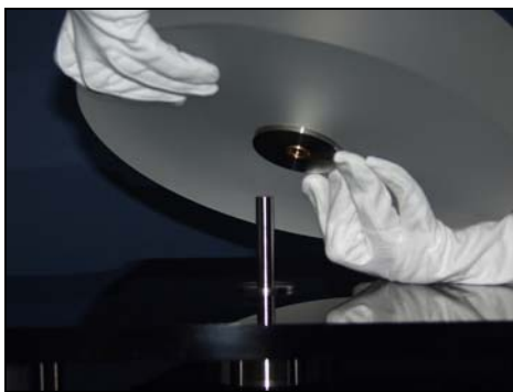
Abbildung 1: Aufsetzen des Plattentellers auf dem Lager
