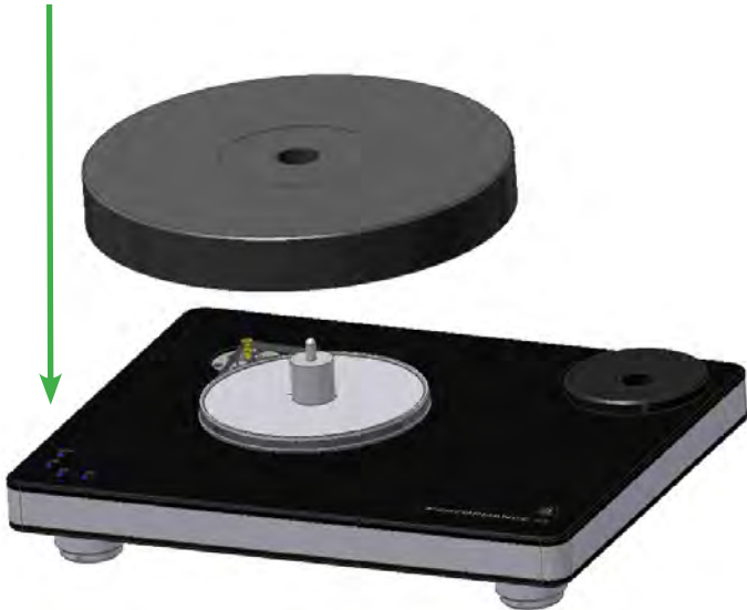
Abb. 8: Aufsetzen des Plattentellers auf das Lager
