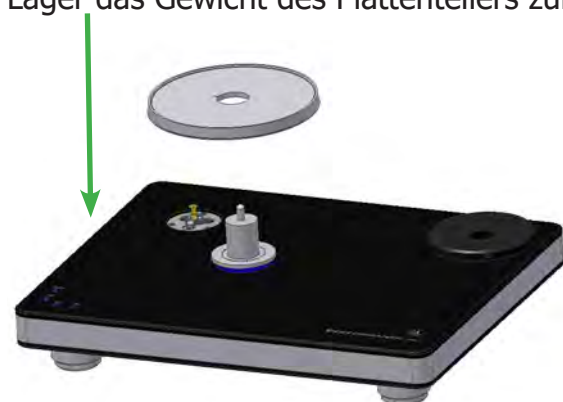
Abb. 7: Aufsetzen des Sub-Tellers
