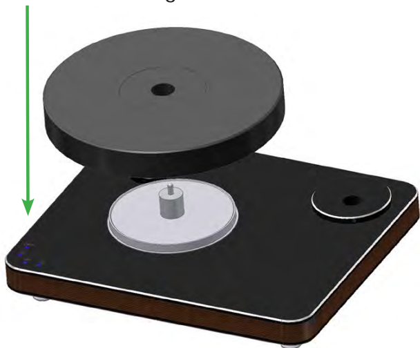
Abb. 8: Aufsetzen des Plattentellers auf das Lager
