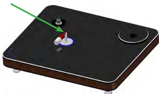
Abb. 5: Ölen der Keramikachse
