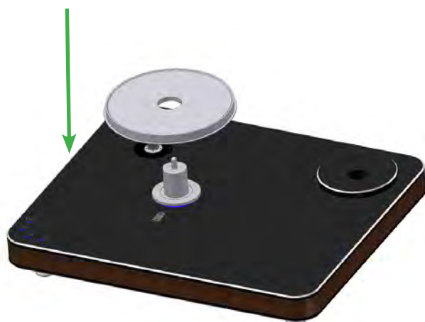
Abb. 7: Aufsetzen des Sub-Tellers
