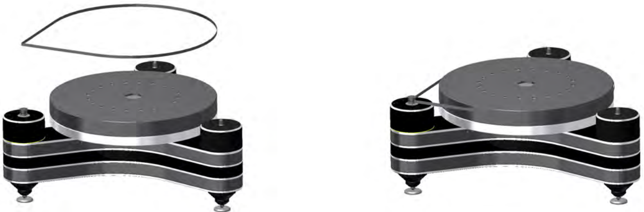
Abb. 10: Umlegen des Antriebsriemens
