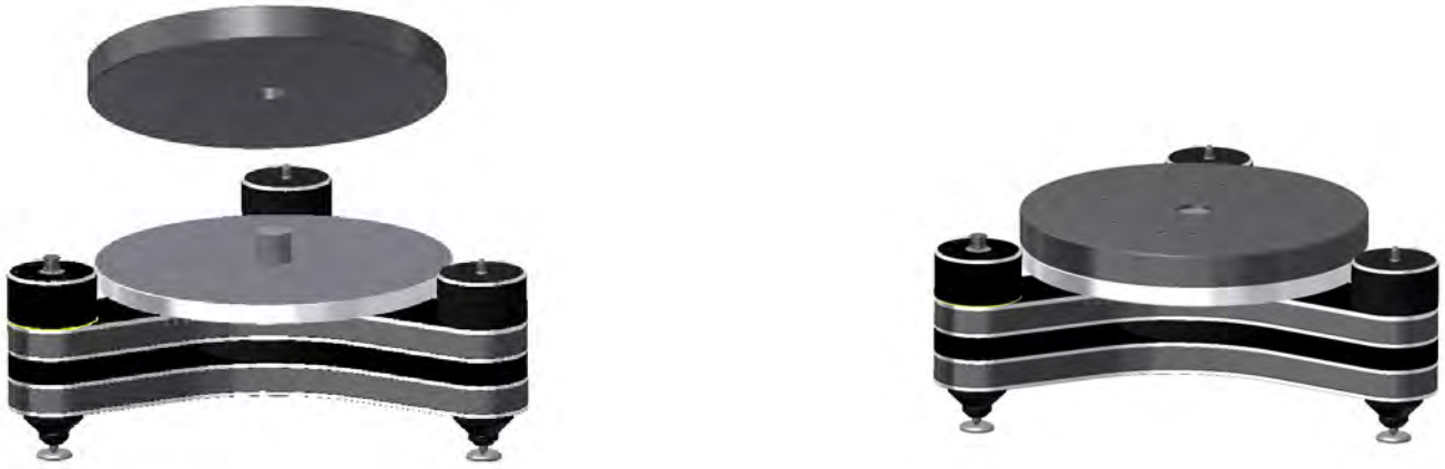
Abb. 9: Aufsetzen des Antriebstellers
