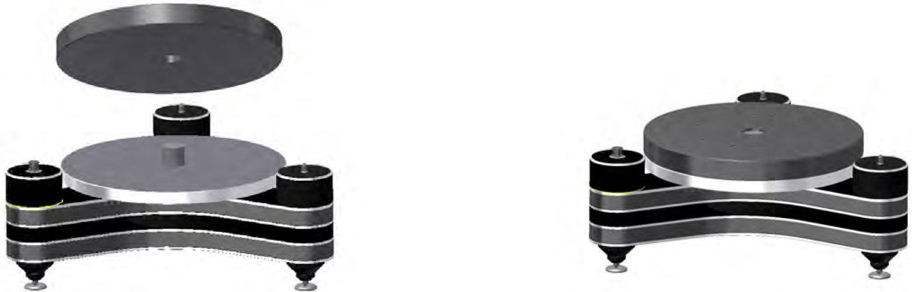
Abb. 9: Aufsetzen des Antriebstellers
