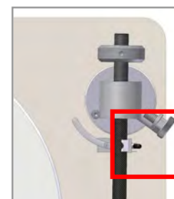
Illustration 3 : antiskating maximal (la vis est entièrement)
