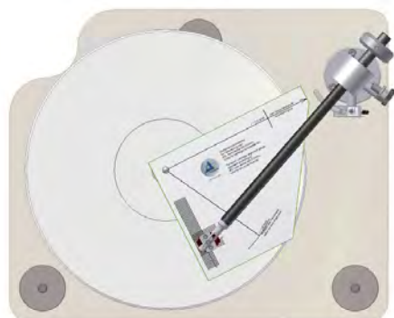
Abb. 10: Absenken des Tonabnehmers auf der Schablone
