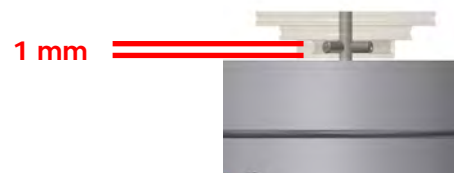
Abb. 12: Befestigen des Antriebsrades
