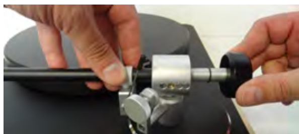
Abb. 2: Montieren des Gegengewichts
