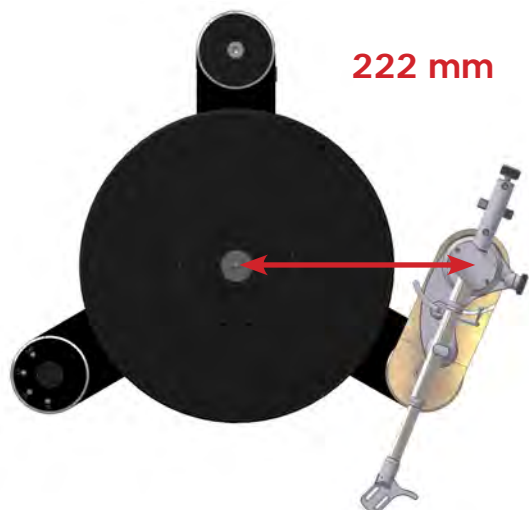
III. 5a: Distance de l'axe au pivot (222 mm)
