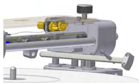
Abb. 7: Einsetzen des Headshells
