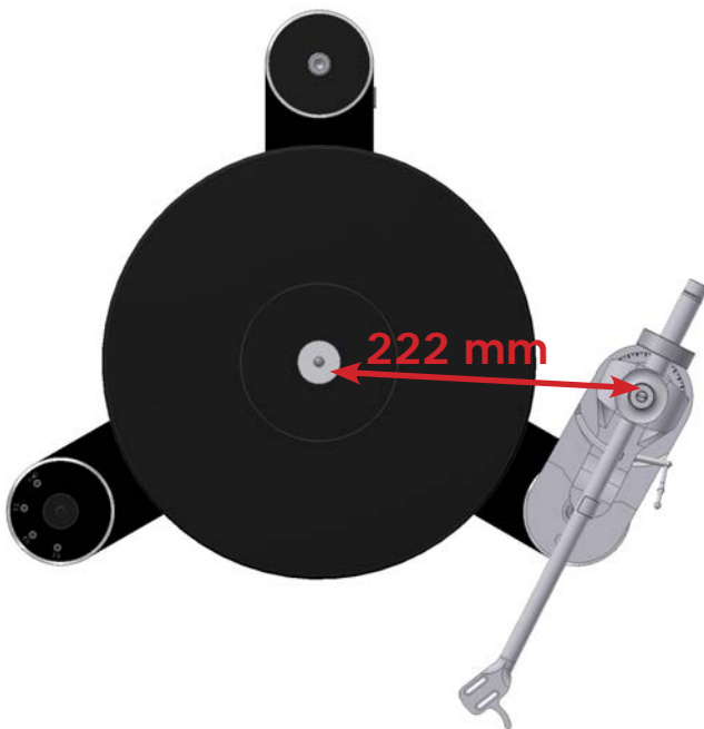
Abb. 5: Abstand der Spindel zum Drehpunkt
