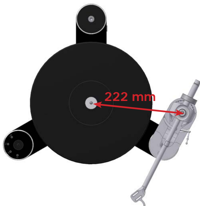
Abb. 8: Abstand Laufwerksspindel zum Tonarm
