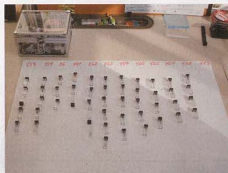
Einzelne Magneten für die Tonabnehmer werden exakt nach Feldstärke selektiert.
