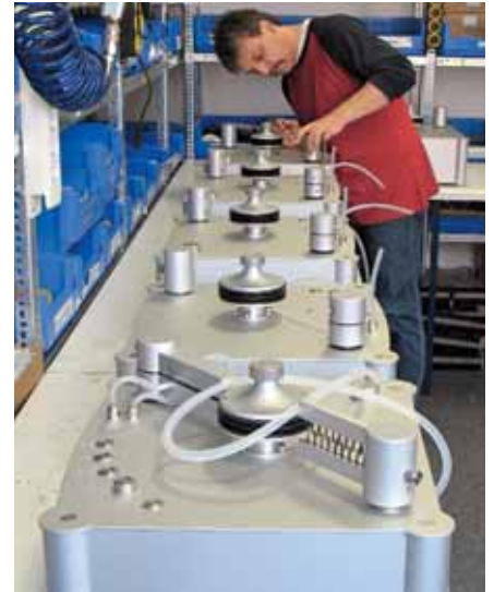
Eine Mitarbeiterin justiert den Tonarm des „Concept“-Drehers, damit der Käufer ihn sofort in Betrieb nehmen kann (u.). Rechts erfolgt die Montage von doppelseitigen Waschmaschinen
