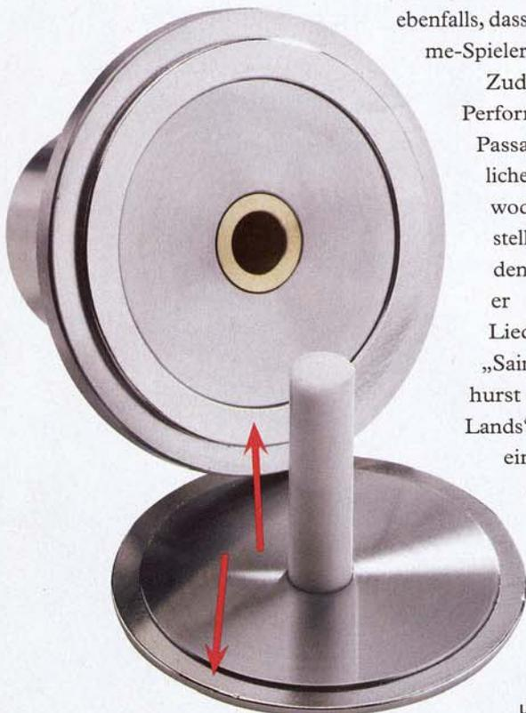
Reibungsfrei: Durch die zwei Magnetrings (Pfeile) aus Neodym schwebt beim Performance das Lager und somit auch der daraufliegende Acrylteller.
