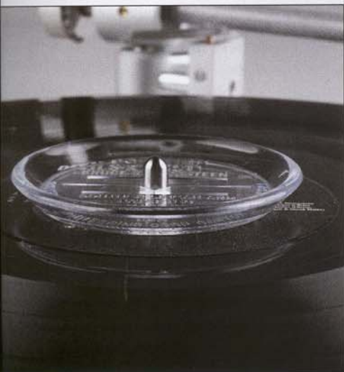
Praktisch: Zum Lieferumfang gehört die Kunststoff-Plattenklemme mit der sich gewellte Platten an den Teller pressen lassen. Die Ausfräsung im Teller für das Label beweist Clearaudios Sinn fürs Detail
