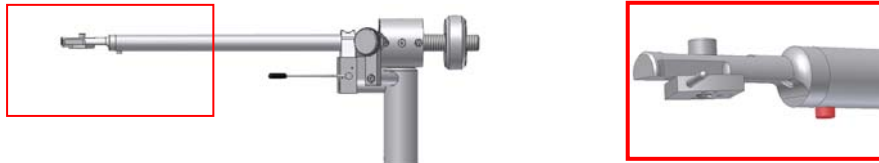
Bild 22 + 23: Lösen der Schrauben am Headshell
