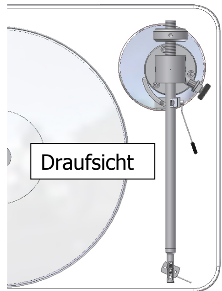
Bild 11: Korrekte Position des Satisfy - Tonarms
