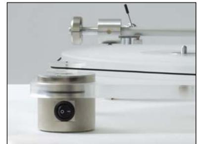
Legen Sie nun den Antriebsriemen um das Antriebspulley des Motors und um den Plattenteller. Der kleinere Durchmesser des Motorantriebsrades entspricht 33 1/3 Umdrehungen pro Minute, der größere obere Rillendurchmesser des Antriebsrades entspricht einer Drehzahl von 45 Upm. Durch Betätigen des seitlich am Motorgehäuse angebrachten Schalters in die Position „I“ setzen Sie das Laufwerk in Betrieb. Es empfiehlt sich, das Laufwerk in diesem Zustand 15-30 Minuten einlaufen zu lassen.
