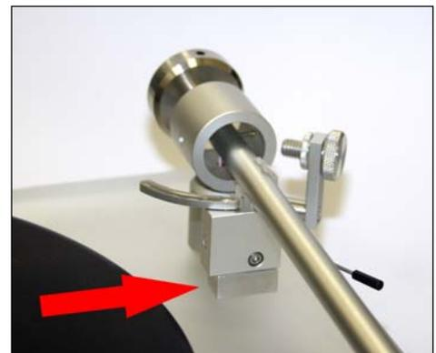
Nehmen Sie den *Satisfy*-Tonarm mit montiertem Tonabnehmersystem (und aufgesetztem Nadelschutz!) und führen zuerst das Signalkabel und anschließend den Fuß des Tonarmes in die dafür vorgesehene Bohrung des *Emotion*- Körpers. Schieben Sie den Tonarm so weit in
