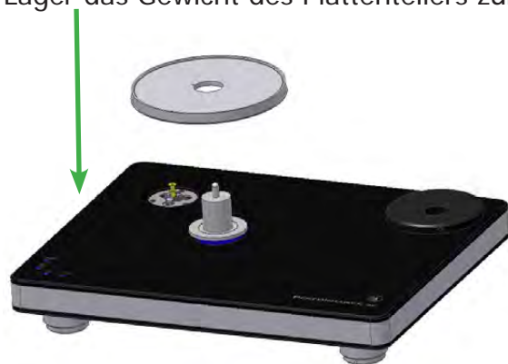
Abb. 7: Aufsetzen des Sub-Tellers
