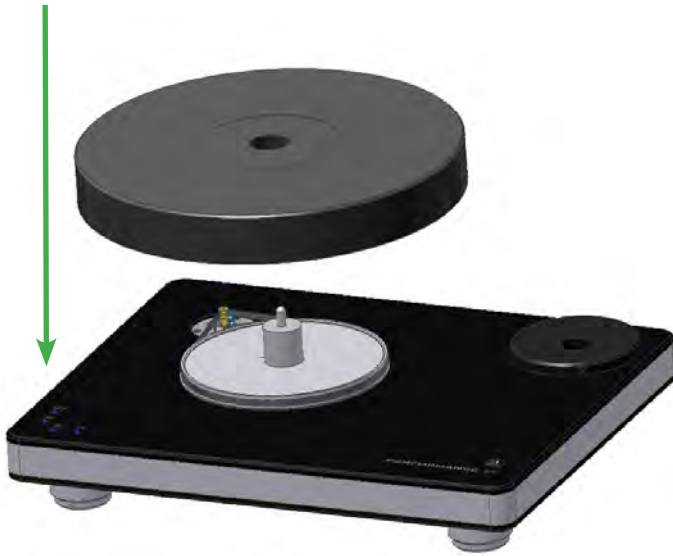
Abb. 8: Aufsetzen des Plattentellers auf das Lager
