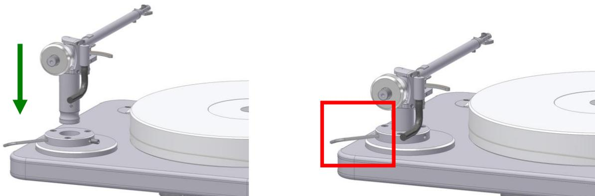
**Abb. 3:** Einsetzen des Tonarms
