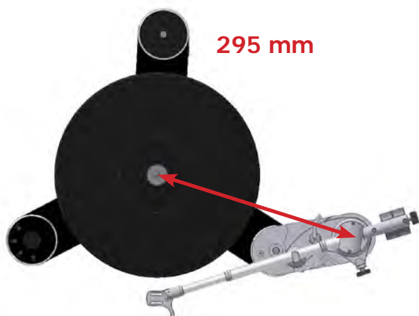
III. 5b: Distance de l'axe au pivot (295 mm) Universal 12"
