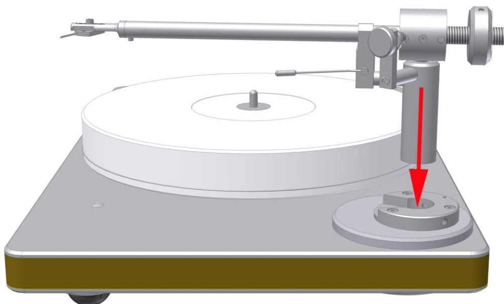
illustration 2: montage du bras de lecture sur l'embase
