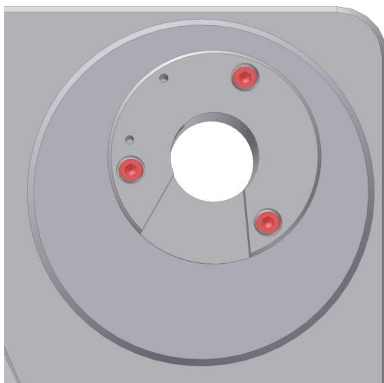
illustration 1: montage de la base du bras de lecture
