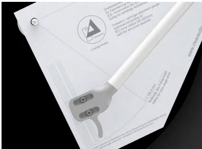
III. 10: Le bras de lecture doit être absolument parallèle aux lignes du gabarit
